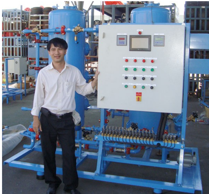
Tủ điều khiển PLC
