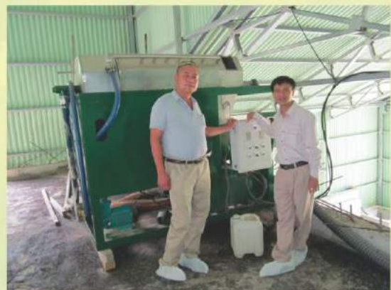
Máy tách chất thải chăn nuôi, công suất 15 m 3 /h
